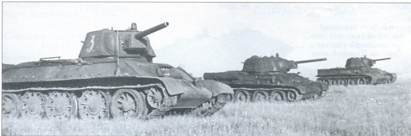
Танки Т-34 перед атакой (обратите внимание, что танки производства разных заводов и отличаются башнями и опорными катками)
