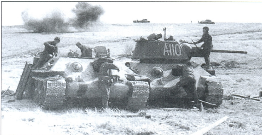
Ремонт подбитых Т-34 прямо в ходе боя. Инженерный танк (без башни) стоит рядом с ремонтируемой «тридцать-четверкой»
