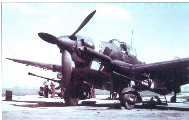
Специальный противотанковый немецкий самолет Ju 87G с двумя 37-мм пушками
