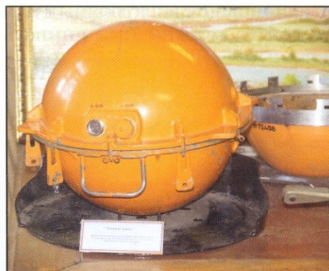
Современный «черный ящик» – на самом деле не ящик, а шар, да еще оранжевого цвета
